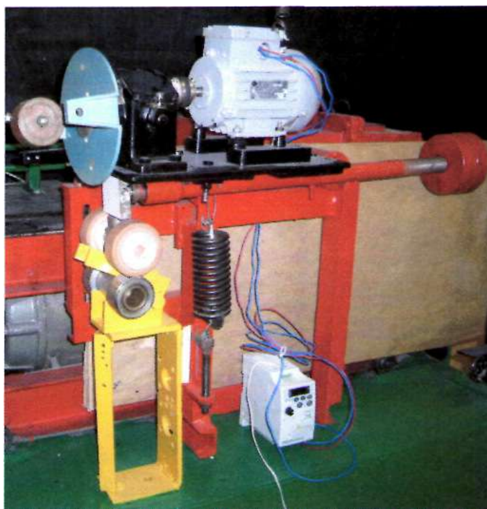
Рис. 2. Стенд для измерения вязкоупругих свойств нажимного валика прядильной машины ПМ-88-А8
