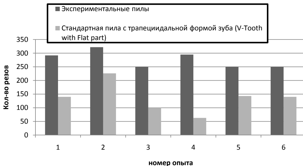
Рис. 3. Сравнительные испытания работоспособности предложенной конструкции пилы со стандартной
