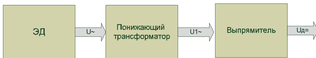
Рис. 3. Структурная схема системы измерения напряжения
